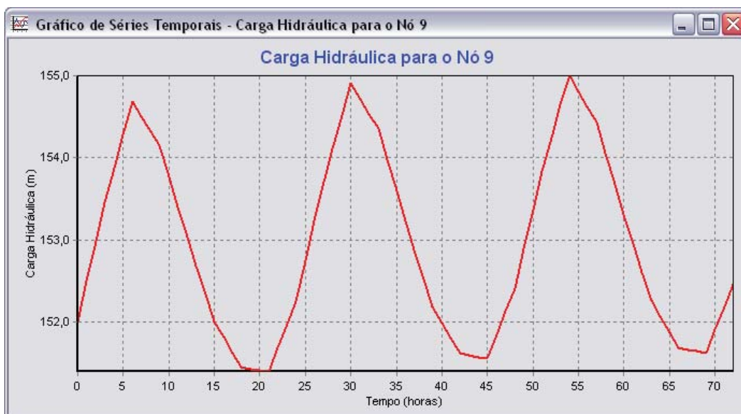
Figura 2.10 - Gráfico de variação da cota piezométrica no RNV.
