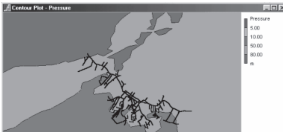
Figura II.6: Apuração das pressões para a área do booster após o modelamento do sistema distribuidor
