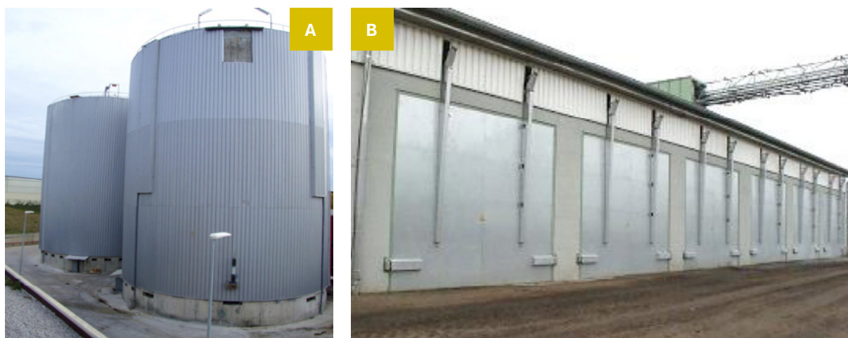
Figura 5: Reatores de metanização com tecnologia baseada em processo seco contínuo (A) e processo seco descontínuo (B)
