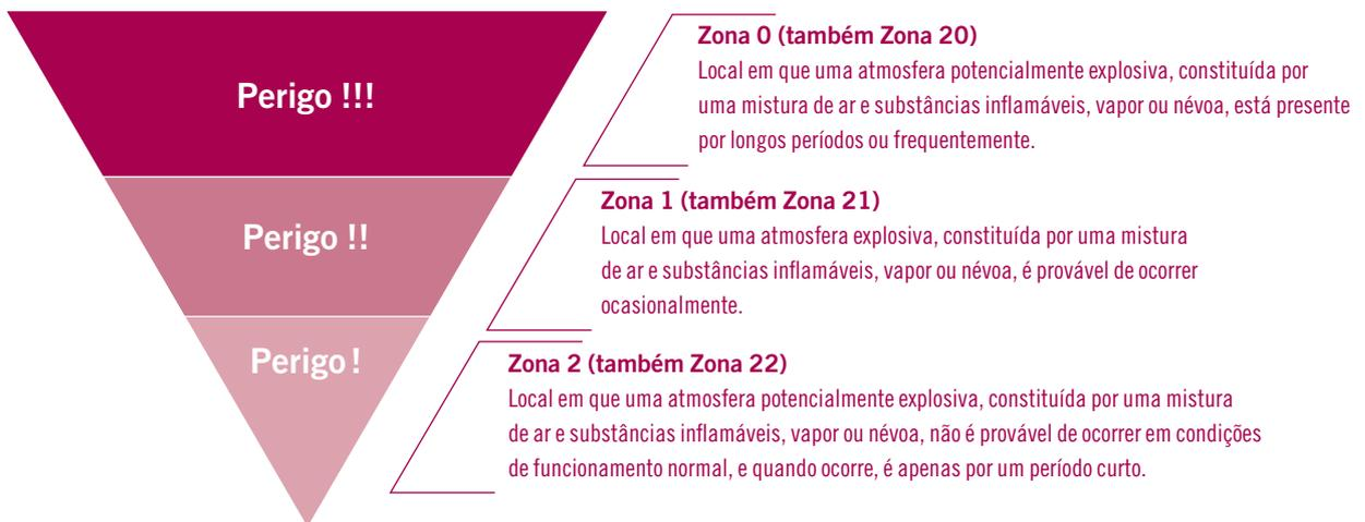
Figura 9: Descrição de uma etiqueta ATEX
