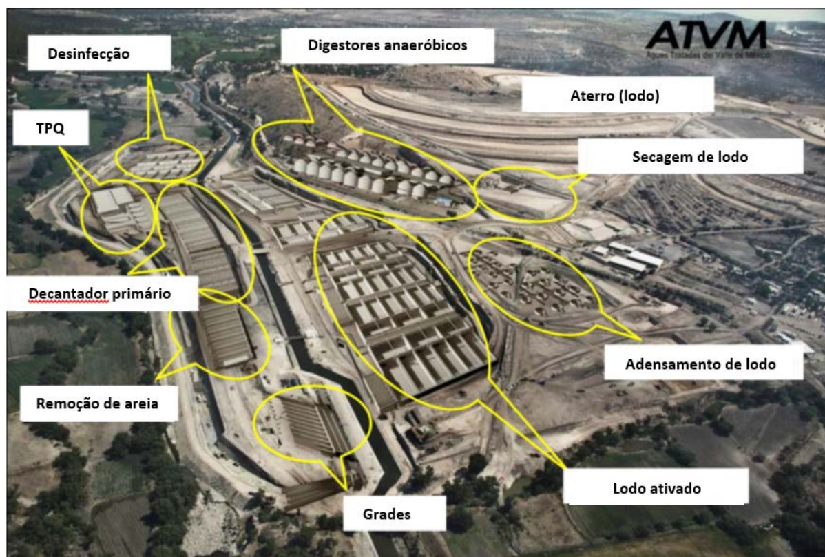
FIGURA 23. ATOTONILCO – LAYOUT 3D DAS INSTALAÇÕES DA ETE
