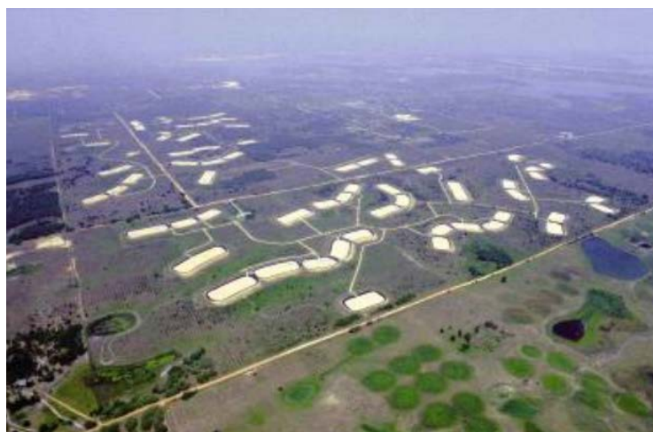
FIGURA 8. REÚSO POTÁVEL INDIRETO – EXEMPLO DE BACIAS DE INFILTRAÇÃO PARA REABASTECIMENTO DO AQUÍFERO EM ORLANDO/FL, EUA
